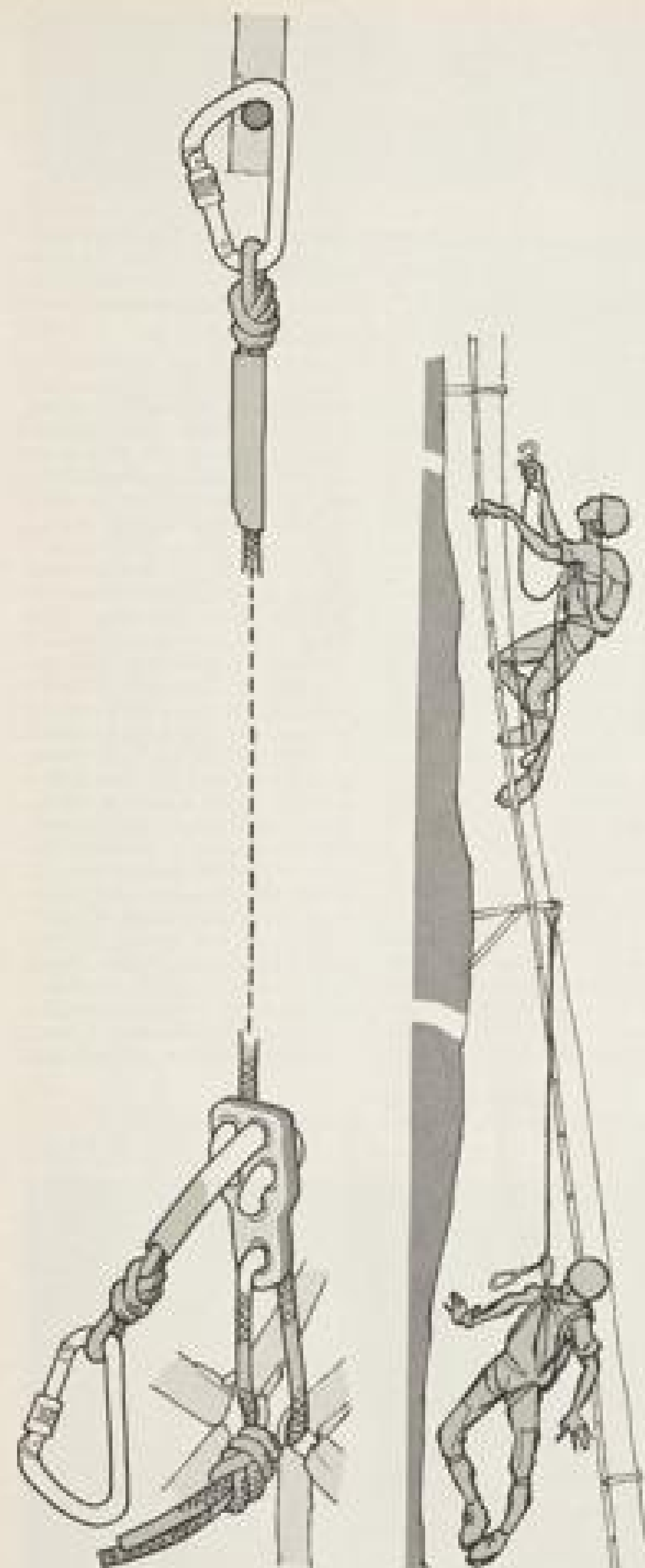
Funktionsweise der Klettersteigbremse.
