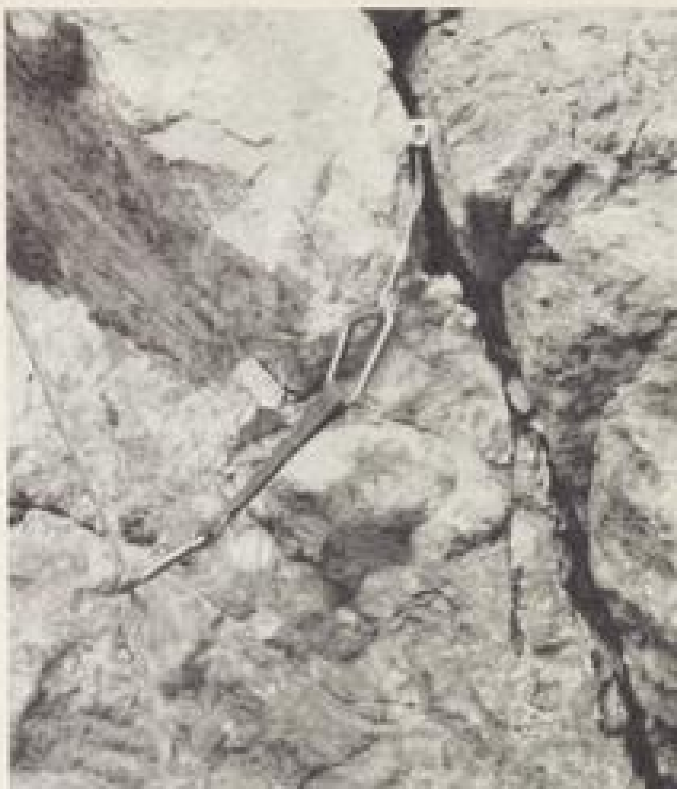
Die Exploföchlinge soll ein Aushebeln des Keils durch Seilzug verhindern; Karabiner zwischen Keil und Schlinge besser umdrehen (Schnapper weg vom Fels).
